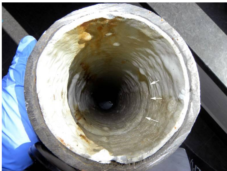
Figur 90. Invändig vy sedd från muffen/kopplingen. Liningen täcker muffövergången (som har markerats med pilar) bra.
