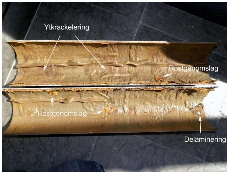
Figur 23. Översiktsbild av det uppsågade provet. Liningen uppvisade en brun missfärgning, men ytan var fortfarande glansig. Rostgenomslag observerades på tre ställen. Ytcrackelering förekom. Liningen satt löst på vissa ställen på grund av stora mängder korrosionsprodukter.
