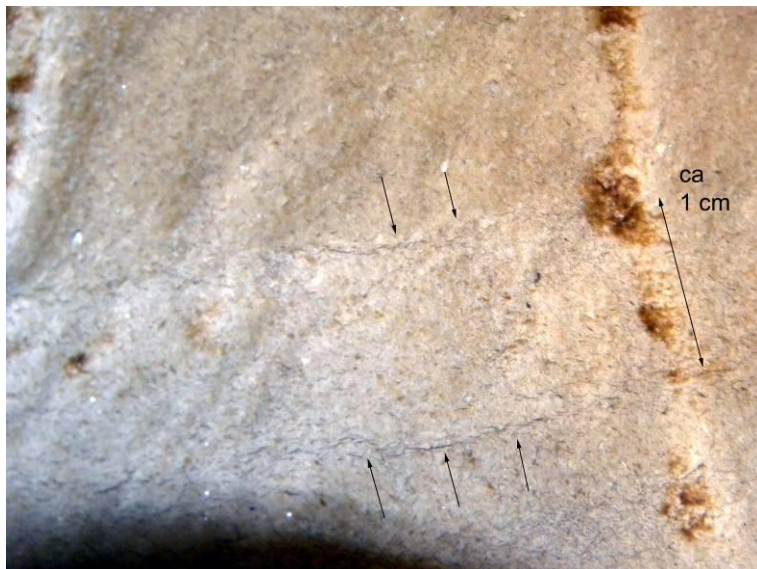
Figur 95. Exempel på små fina sprickor i axiell riktning. Dessa var av annan karaktär än ytkrackelering eftersom de alltid var orienterade i längdriktningen. Några av dessa sprickor undersöktes vidare under ljusmikroskop. (Se vidare figur 99.)
