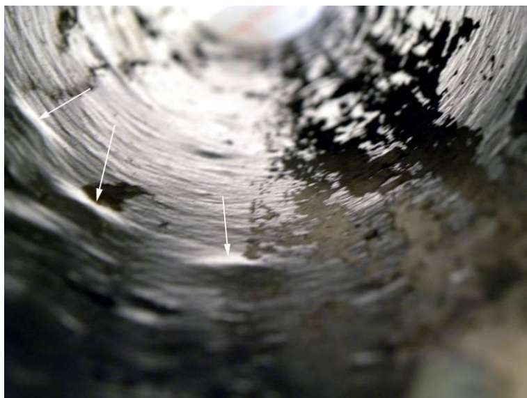
Figur 50. Pilarna markerar små upphöjningar i liningen. Närmare undersökning visade dock att dessa inte var osmosblåsor eller luftinneslutningar utan endast materialansamlingar (små solida bulor).
