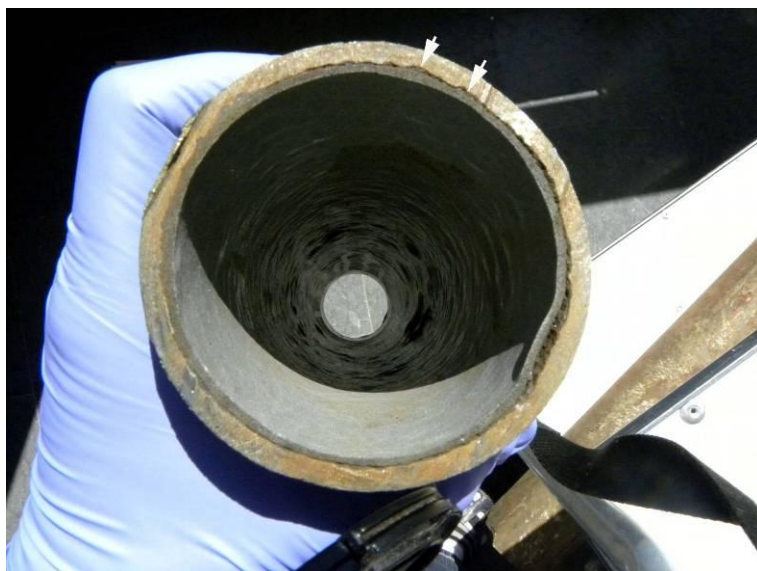
Figur 40. Invändig vy. Ytan och tjockleken föreföll vara någorlunda jämna. Liningen verkade ha bra vidhäftning till underlaget och hade släppts från underlaget på bara några ställen. (Vid den stora släppningen på höger sida drogs liningen loss manuellt.) Grafitering hos gjutjärnsröret förekom endast i mindre uträkning. Inga större mängder lösa korrosionsprodukter fanns.
