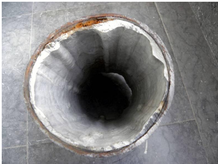
Figur 67. Invändig vy. Liningens tjocklek visade stora variationer. Axiella valkar fanns. Gjutjärnsröret uppvisade grafitering och i en del förekom lösa korrosionsprodukter. På några ställen hade liningen släppts från underlaget.
