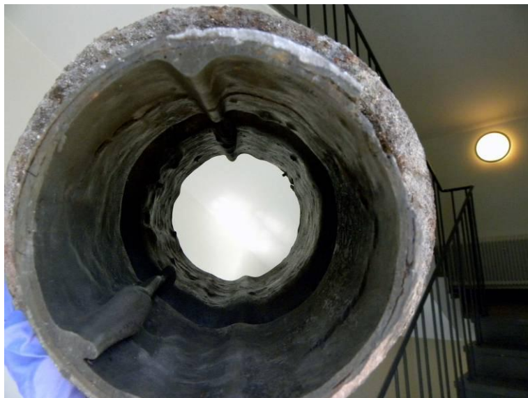
Figur 1. Invändig vy. Stora tjockleksvariationer förekom vid valkar och där materialet hade droppat ner. Droppriktningen visade att röret var placerat vertikalt.
