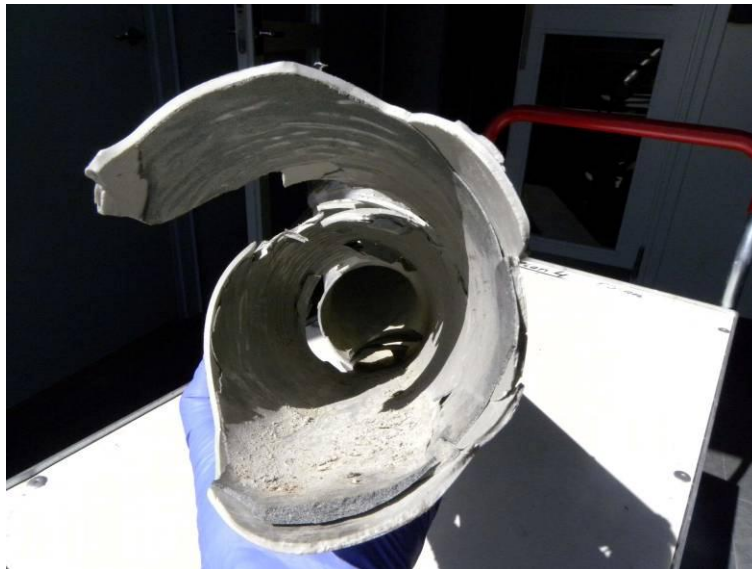
Figur 32. Invändig vy sedd från den raka rördelen. Tjockleksvariationerna var små. Röret var mycket kraftigt skadat.
