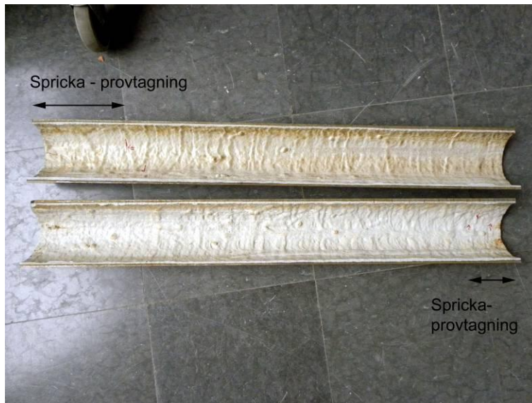
Figur 84. Översiktsbild över det uppsågade röret. Inga skador som sprickor i axiell eller omkretsriktning hittades utöver dem som uppkommit i samband med provtagningen.
