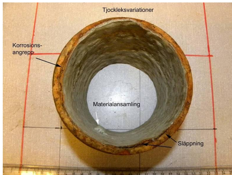
Figur 56. Invändig vy. Liningens tjocklek verkade tunn och uppvisade viss variation både i omkretsriktning och längdriktning. En materialansamling fanns i mitten av provet. Gjutjärnsröret uppvisade kraftigt korrosionsangrepp, och på flera ställen hade liningen släppt.
