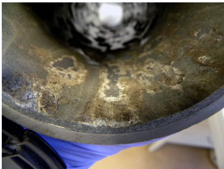
Figur 51. Viss beläggning förekom i röret. Liningen under beläggningen verkade vara i samma kondition som den friliggande liningen.
