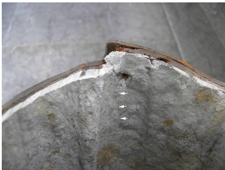
Figur 69. Skada i form av spricka och håligheter som bildats i samband med provtagningen.
