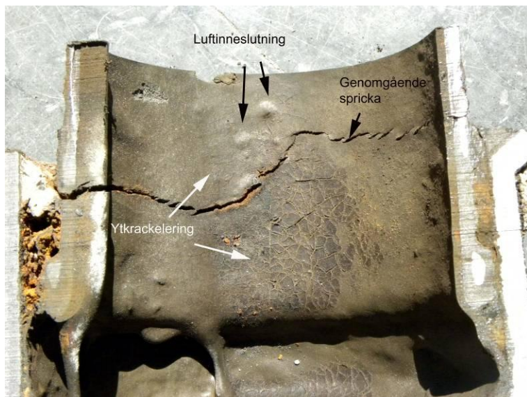
Figur 3. Förstoring av den halvan av muffen/kopplingen som uppvisade kraftigare ytcrackelering. Den genomgående sprickan är markerad. Dessutom visade sig de två markerade blåsorna innehålla luftinneslutningar.
