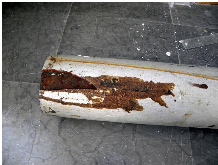
Figur 80. Röret var skadat vid ena ändan. Även liningen visade sprickbildning i detta område, tydligen härstammande från provtagningen.
