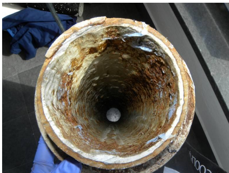
Figur 83. Invändig vy sedd från muff/kopplingssidan. Liningen täckte muffövergången bra.
