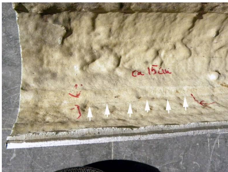
Figur 94. En annan spricka utan direkt anslutning till, men nära sågningskanten. Även den uppkom troligen vid provtagningen.
