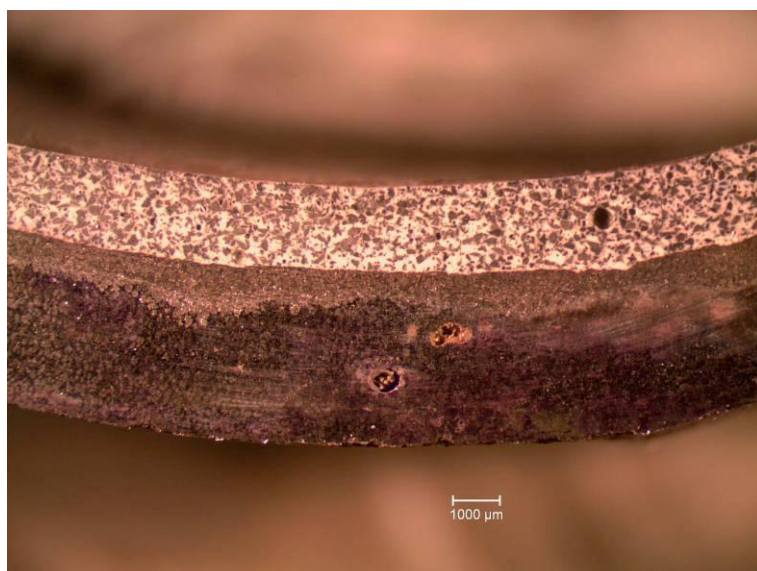
Figur 19. Polerat tvärsnitt som visar liningen och gjutjärnsröret. Provet har tagits från ett ställe utan ytkrackelering. Gjutjärnsröret uppvisade här grafitering, men inga lösa korrosionsprodukter förekom. Vidhäftningen föreföll vara bra. Gummipartiklarna syntes i epoximatrisen. Liningen innehöll en mindre mängd luftinneslutningar.
