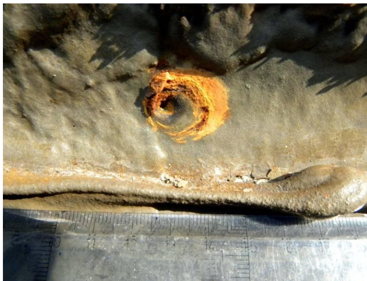
Figur 29. Bild på det tredje området med rostgenomslag. Här verkade liningen vara tjockare, men hade antagligen inte täckt hela gjutjärnsröret. En por syns.
