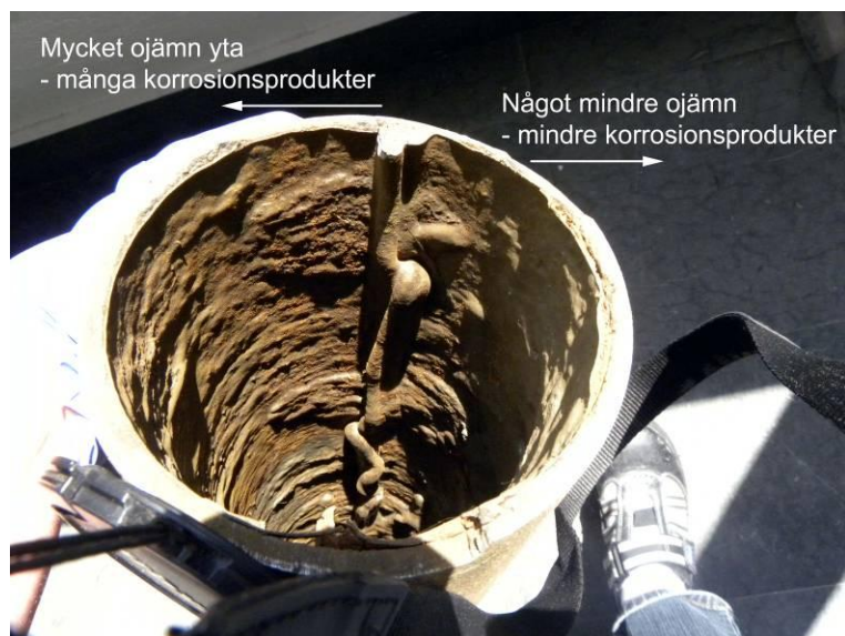
Figur 22. Invändig vy. Stora tjockleksvariationer observerades och valkar förekom.
