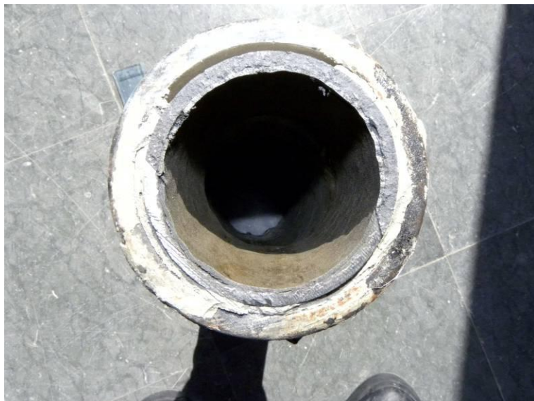
Figur 13. Invändig vy. Inga stora tjockleksvariationer observerades, inga valkar förekom.
