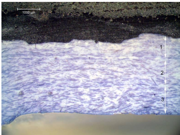
Figur 86. Polerat och infärgat tvärsnitt. Infärgningen visar tre tydliga lager.
