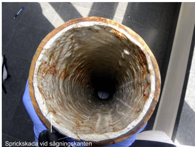
Figur 82. Invändig vy sedd från rörsidan. Det förekommer vissa tjockleksvariationer i liningen. Sprickorna som syns i sågningskanten har uppkommit i samband med provtagningen.
